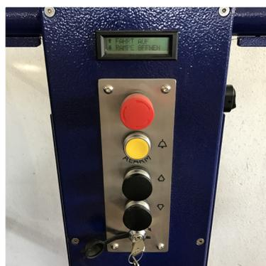
**Contrôle sur plateforme** avec bouton d'arrêt et d'alarme ainsi que une indication digitale de l'état de la plateforme
